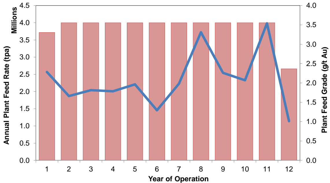
Figure 7: Profil du tonnage et de la teneur du minerai de l'usine (Scénario 2)
